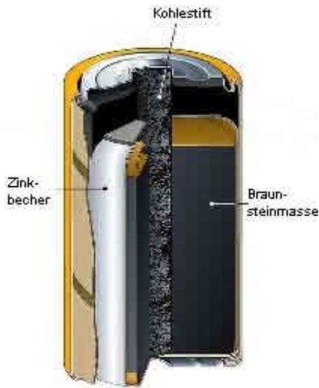
Die übliche Zink-Kohle-Batterie besteht im Wesentlichen aus einem Zinkbecher, in den eine eingedickte Salmiaklösung ( $\text{NH}_4\text{Cl}$ ) und Braunstein ( $\text{MnO}_2$ ) gefüllt sind. In diesem eingedickten Brei - man nennt diesen Batterietyp daher auch Trockenbatterie - steckt ein Kohlestift. Die Spannung einer frischen Zn-C-Zelle beträgt 1,5 V.
