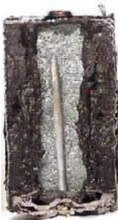
Schneidet man eine stark gebrauchte Zn-C-Batterie (z.B. Monozelle) auf, so sieht man, dass der Zinkbecher stark zerfressen ist. Offensichtlich findet bei Stromentnahme eine Zersetzung des Zinks statt.
