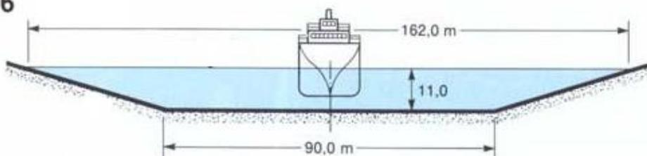
Der Kanal kann von Schiffen mit einer Länge bis zu 235 m und 32,5 m Breite genutzt werden. Der zulässige Tiefgang für Schiffe beträgt 9,5 m und die Mastenhöhe der Schiffe darf nicht mehr als 40 m über dem Wasserspiegel betragen.
